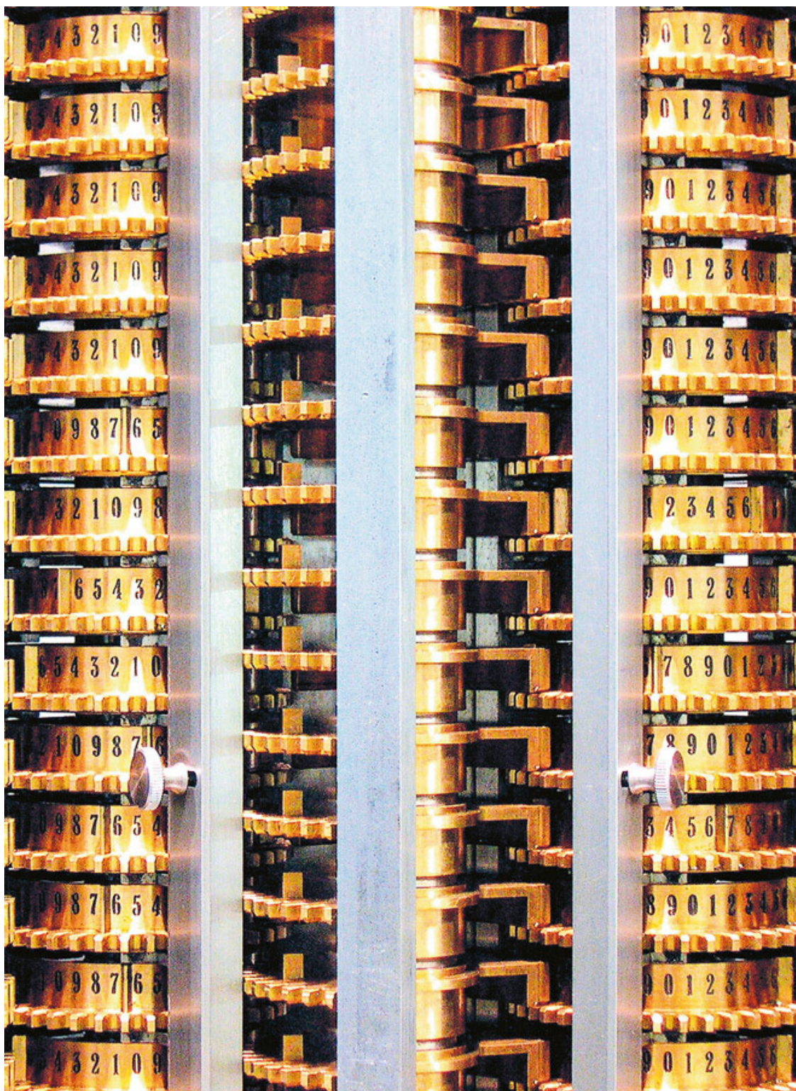
Рабочая модель части разностной машины Чарльза Бэббиджа. В настоящее время хранится в лондонском Музее науки.
