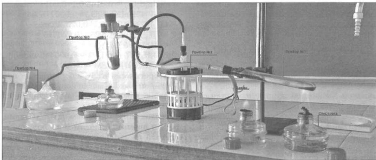
гревали до слабого кипения. Затем зажгли спиртовки под прибором 1 для получения этилена (сначала сильно нагревается катализатор, затем полиэтилен – до закипания). Постоянно следили за равномерностью нагревания в пробирке 1 и реакторе 3.
